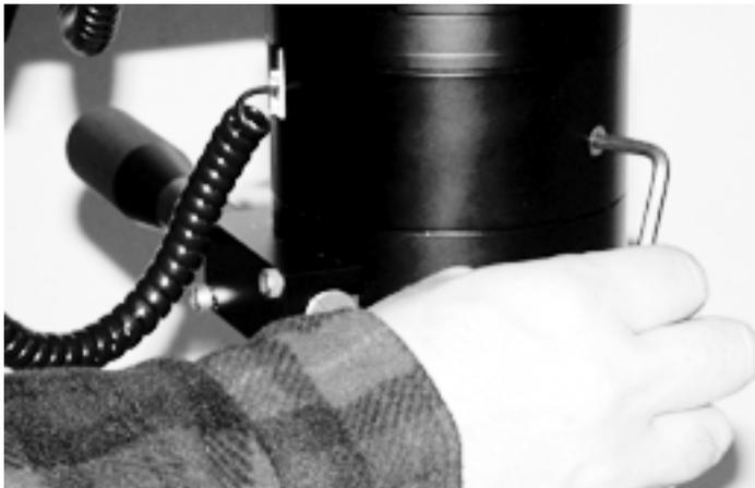
M10イモネジ用レンチは両軸の側面にある、M10イモネジのための物ですが、このM10イモネジは内部にあるエンコーダーシャフトと架台の回転軸を接続している部分にアクセスするための蓋の役割をしているもので、万が一エンコーダーシャフトと架台の回転軸の接続部が弛んだ場合など、もう一つの付属レンチである、M3イモネジ用のレンチを使用するための穴の蓋となっています。
