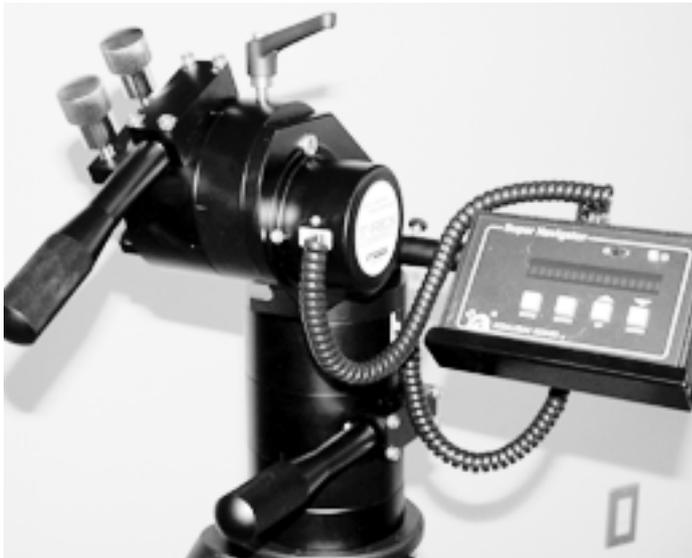
最後にクランプレバーを両軸に取り付け、エンコーダーケーブルを差し込めば基本的にT-rexの組み立ては完了です。組み立て前の状態ではクランプレバーをねじ込む穴には、他のネジがねじ込まれていますが、これは内部への埃などの進入を防ぐための物なので、クランプレバーの取付の際にはこれを外して下さい。
