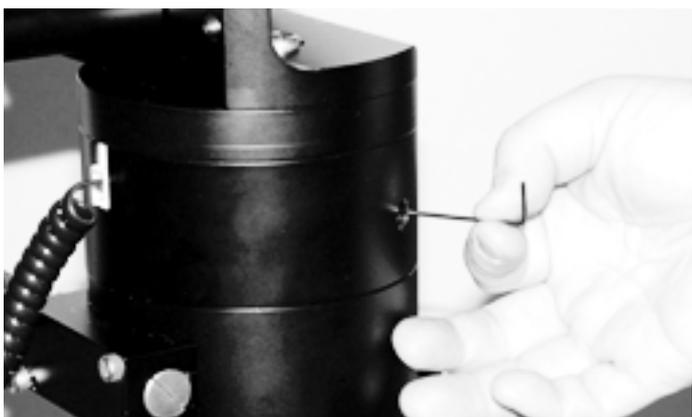
したがってなにがしかの理由でエンコーダーシャフトを外したり締め付けたりする場合はM10イモネジ外してから、内部にあるM3イモネジにアクセスして下さい。
