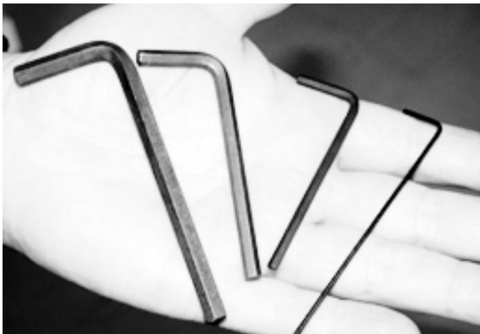
画像左より、M8キャップスクリュー用 / M10イモネジ用 / M5イモネジ用 / M3イモネジ用。上記の4種類が付属されています。実際に良く使うとすれば、M8キャップスクリュー用とM5イモネジ用です。
