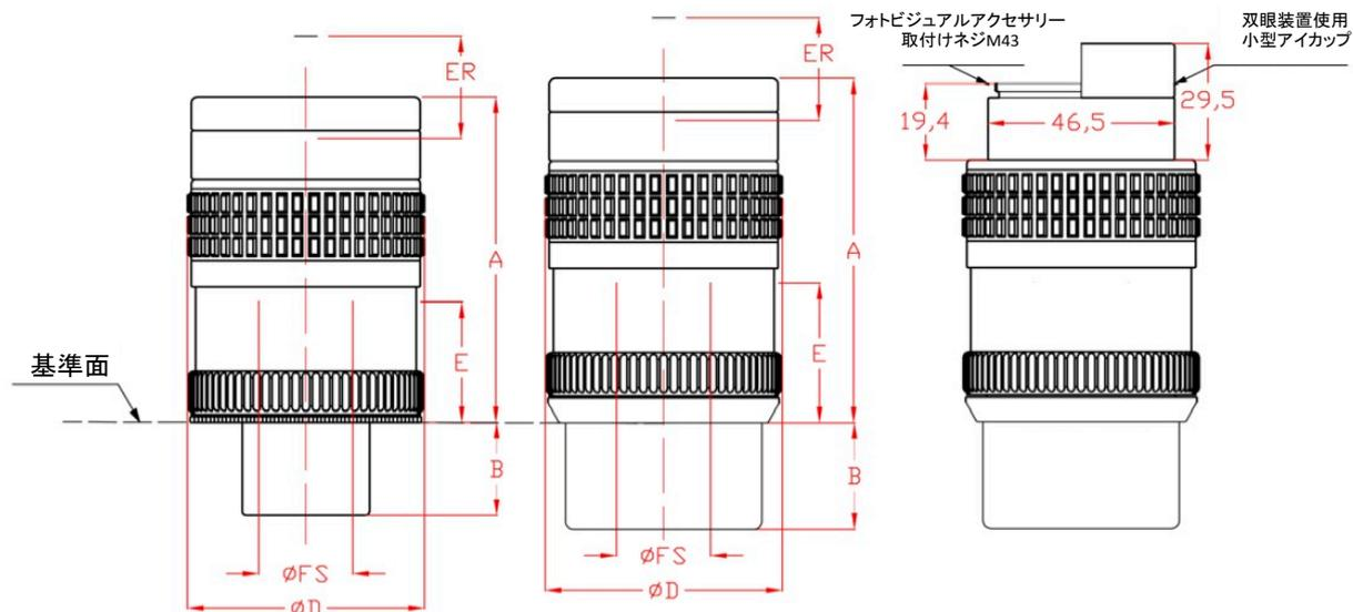
ハイペリオン マークⅢアイピースの付属品の使用により、上記図面の様に3種類の接眼位置が変動致します。
