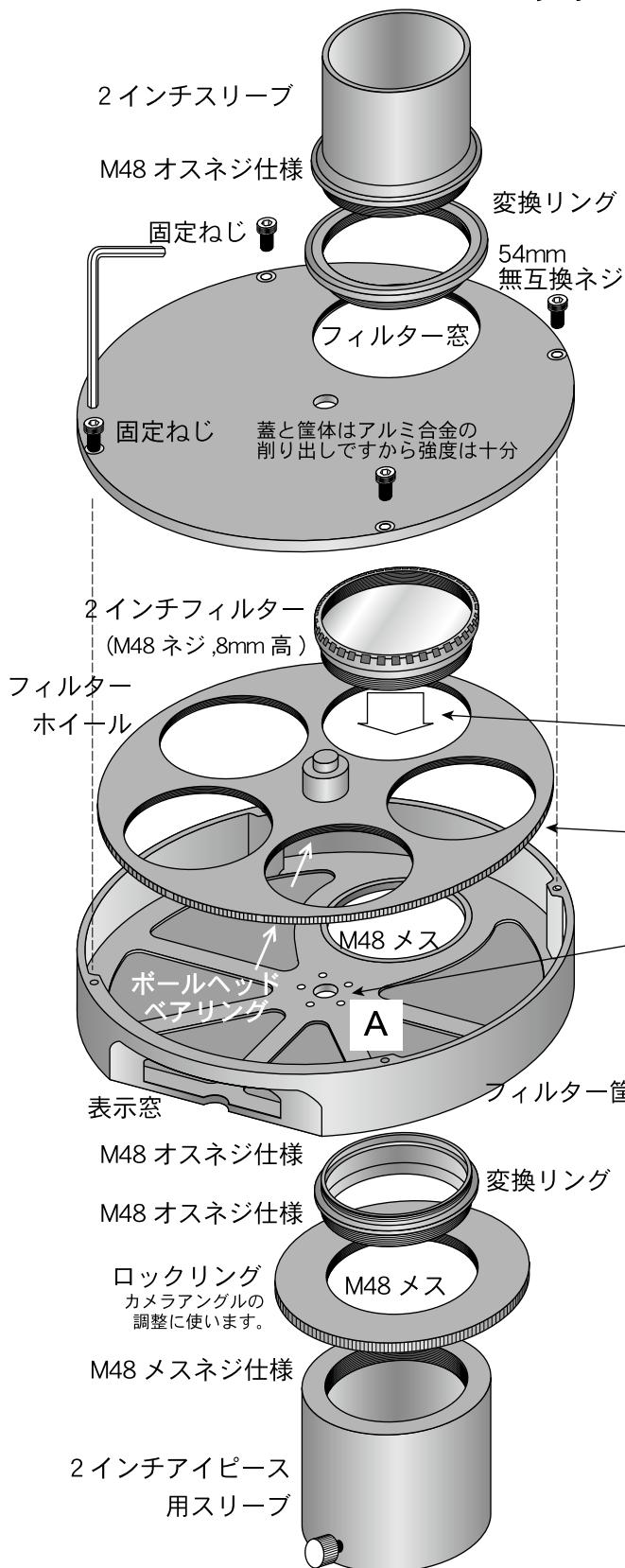
フィルターの着脱は、本体裏面を外し内部のフィルター ホイール回転板にアクセスする必要があります。取り外す場合には、下図を参考に「A」の穴位置に合うように正しく回転板を取り付けます。
